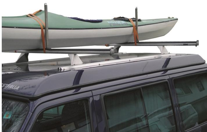
GFK-Hubdach mit Caravanschiene und Anschraubfüßen AA
